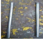
2.Şekil: 316L (1,4404) paslanmaz çelik 7 mm demir. 3. Şekil: Kesilmiş matkap ucu
